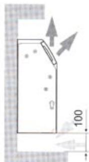
Ventiloconvectoare FA, cu montare pe perete, potrivite pentru montarea în nișe.
