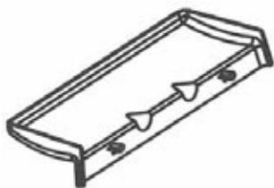
Tava de colectare condens **BH** poate fi utilizată la ventiloconvectoarele cu instalare orizontală pentru colectarea eventualului condens care se poate forma la valva ON/OFF cu 3 căi (accesoriul **VK S**).
