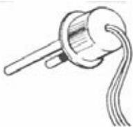
**Termostat oprire ventilator** cu rearmare automată, acționează prin oprirea ansamblului motor ventilator când temperatura în schimbător scade sub valoarea prestabilită. (42°C).
