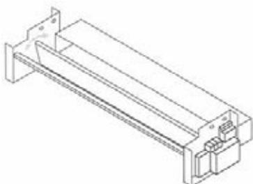
Kitul pentru aport de aer proaspăt acționat cu servomotor permite reîmprospătarea aerului din cameră direct de la ventiloconvector.
