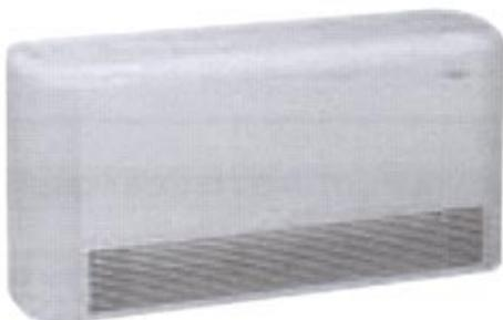
**Carcasa unității** este realizată din panouri de tablă groasă de oțel (10/10 mm), cu lateralele și grilajul la ieșire (care se poate orienta cu 180°) din ABS. Ușile laterale permit accesul la spațiul tehnic interior și la panoul de control (opțional).
