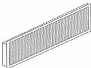
Grilaj ieșite aer cu două rânduri de aripioare din aluminiu anodizat, orientabile, și contra-ramă din tablă de metal galvanizată; este de obicei folosită la ventilconvectoarele montate prin încastrare.
