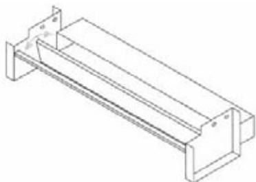
Kitul pentru aport de aer proaspăt permite reîmprospătarea aerului din cameră direct de la ventiloconvector.
