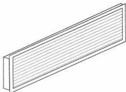
Grilaj aspirație aer cu aripioare fixe din aluminiu anodizat, cu contra-ramă din tablă de metal galvanizat; este de obicei împreună cu clapetele de aspirație aer proaspăt și sunt destinate montării pe perete.
