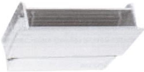
**Structura de rezistență** este din tablă groasă de oțel galvanizat (până la 15/10 mm), izolată cu panouri de izolație căldură cu auto-stingere, Clasa 1 și dotată cu kit de instalare (șuruburi de perete). Unitatea este prevăzută cu sistem dublu de colectare și evacuare condens; în cazul instalării orizontale condensul este colectat într-o tavă largă de colectare.
