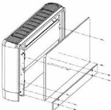
Acest accesoriu este destinat instalării la modelele **FL, CL și FU** de ventiloconvectoare, cu partea posterioară la vedere.
