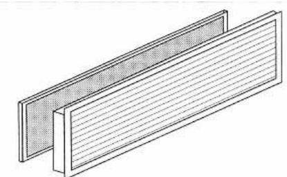
Grilaj aspirație aer cu aripioare fixe din aluminiu anodizat cu filtru din fibre acrilice lavabil și contra-ramă din tablă de metal galvanizat; este de obicei folosită la ventilconvectoarele montate prin încastrare.
