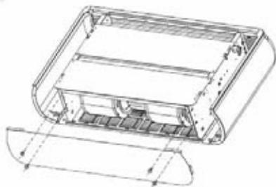
Panoul posterior vopsit **PH** este destinat pentru modelele **ESTRO FU** doar pentru montare pe tavan, cu partea din spate a unității la vedere, pentru acoperirea spațiilor tehnice (hidraulice și electrice). Ventilconvectoarele cu panouri **PH** pot funcționa doar în modul încălzire.
