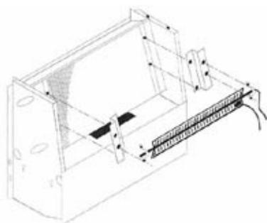
Este util pentru integrarea încălzirii convenționale la sistemul de apă caldă. Kitul **RE** este realizat dintr-o rezistență electrică cu termostat de siguranță (resetare automată și manuală) și releu de putere. Kitul RE trebuie combinat cu panoul de control **MICROPRO** sau **MICROPRO-D**.
