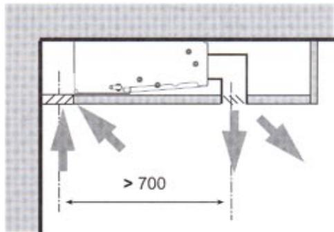
Ventiloconvectoare FC cu corp ascuns, montare pe tavan. Ștuțul de ieșire aer arătat în figură nu este furnizat.
