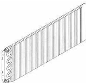
Schimbătorul de căldură suplimentar realizat din țevă de cupru și aripioare din aluminiu este folosit pentru sistemele cu 4 țevi și trebuie conectat la circuitul de încălzire. Schimbătorul de căldură este completat de un robinet de purjare aer plasat pe conexiunile hidraulice.
