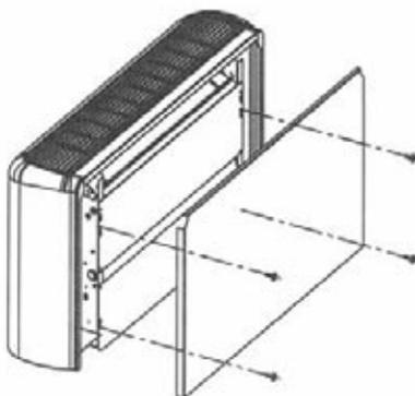
Acest accesoriu este destinat instalării la modelele **FB** de ventiloconvectoare, cu partea posterioară la vedere.
