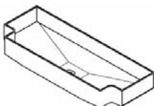
Acest accesoriu este destinat colectării eventualului condens care se poate forma la valvă sau suport. Se poate utiliza la unitățile **ESTRO** - unități cu montare verticală: **FL, CL, FA, FU, FC, FB**.
