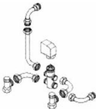
Kitul **VK** - valvă motorizată ON/OFF cu 3 căi / 4 porturi, conectată la panourile de control ale unităților **ESTRO** permite reglarea temperaturii în cameră întrerupând debitul de apă spre schimbătorul de căldură.
