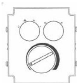
Este destinat pentru instalare încorporată, pe partea opusă panoului de control al ventiloconvectorului și permite deschiderea și închiderea proporțională de la 0 la 100% a kitului **SM - SM-C**.
