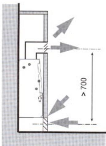
Ventiloconvectoare FC cu corp ascuns, montare pe perete. Ștuțul de ieșire aer arătat în figură nu este furnizat.
