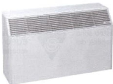
**Carcasa unității** este realizată din panouri de tablă groasă de oțel (10/10 mm), cu lateralele și grilajul la ieșire (care se poate orienta cu 180°) din ABS. Ușile laterale permit accesul la spațiul tehnic interior și la panoul de control (opțional).
