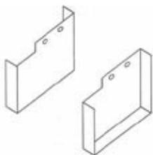
Distanțierile de susținere D sunt livrate în perechi și pot fi montate la unitățile ESTRO FC cu montare verticală încastat în perete, când nu este posibilă fixarea unității de perete.
